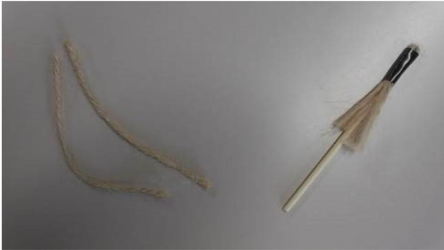
写真-5.4 使用した芥材料（左）及び偏芯させた流木模型（右）の様子
