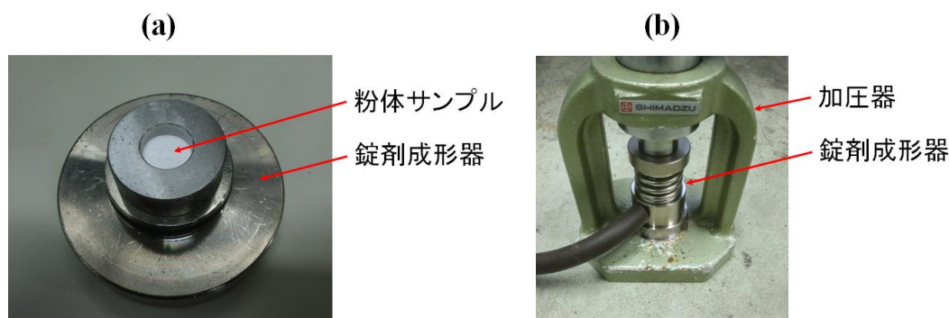
Figure 4.6. ペレット作成. (a): 錠剤成形器に粉体サンプルを充填する. (b): 装置を用いて加圧.
