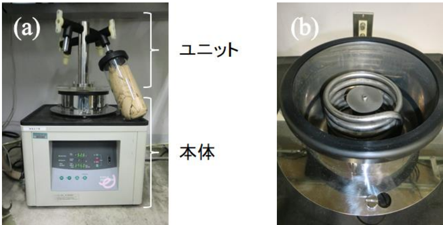
Figure 3.3. FDU-1200 の外観。 (a) : 凍結乾燥機, (b) : 装置内部の冷却コイル。
