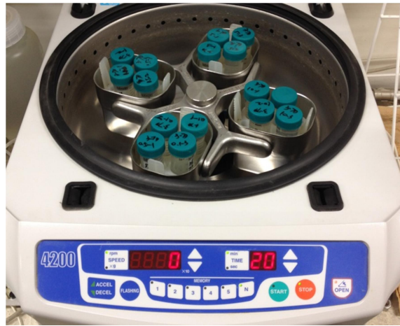
(d) Centrifugation under 3,000 rpm
