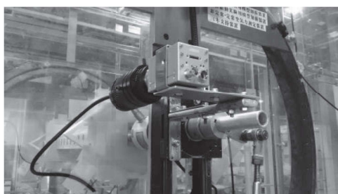
写真 6 製作した固定金具に取り付けたカメラ
