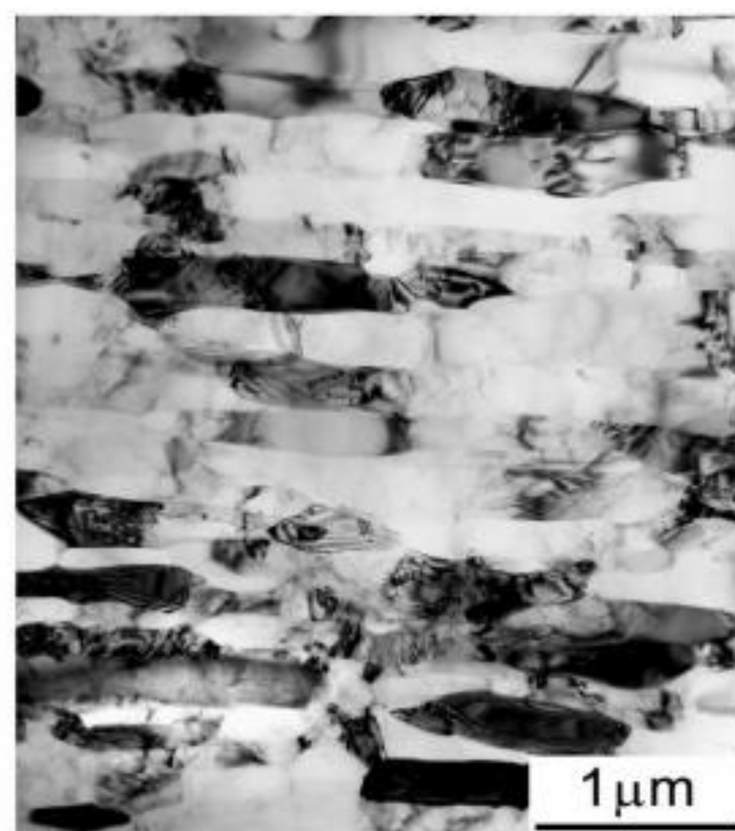
ARB 法により作製された超微細粒アルミニウムの透過電子顕微鏡 (TEM) 写真
