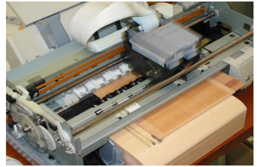
図1. インクジェット法を応用した接着剤微量塗布装置
