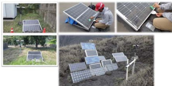
図 7. ソーラーパネル清掃後と 降灰サンプリング作業
