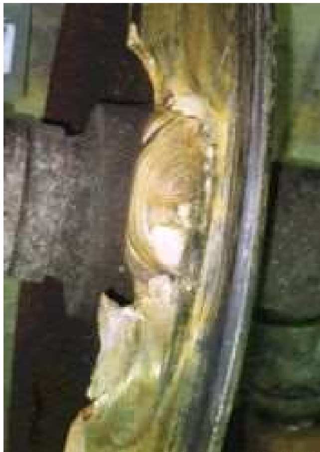
Fig. 41 リム大型はく離の一例
