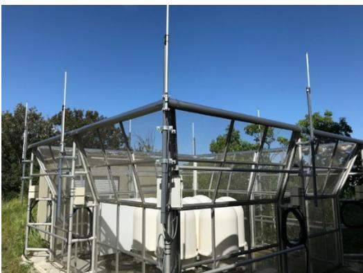
Photo 1 Wind Profiler (Above) ,Sub-array antennas.
