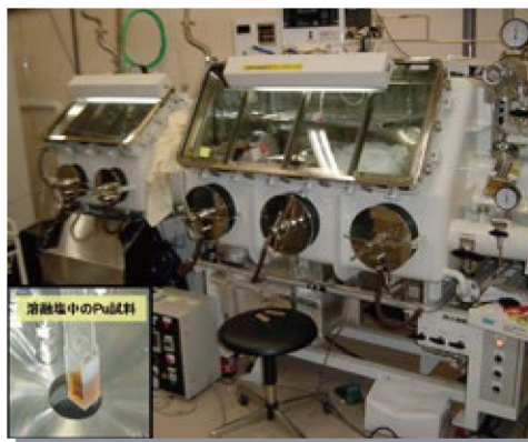
図1:アクチノイド元素の化学特性を調べるグローブボックス
