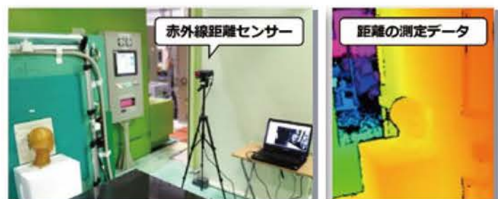
図:赤外線距離センサーを用いた位置ずれ測定の様子
