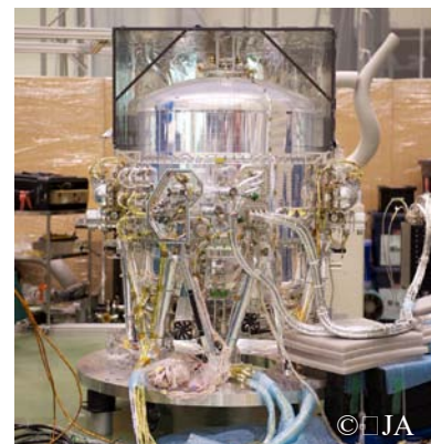
「ひとみ」衛星に搭載された、マイクロカロリメータ検出器の真空断熱冷却容器
