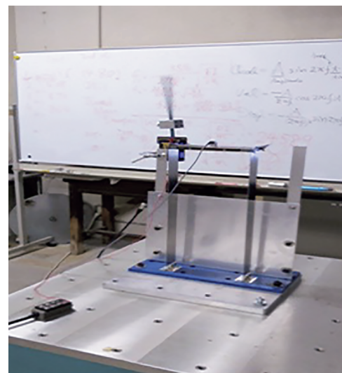
写真5 模型の振動状況(重りあり)
