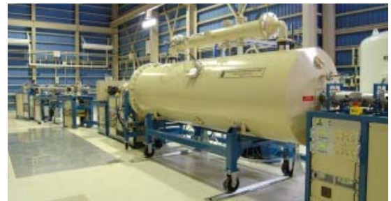
図 1.マイクロイオンビーム解析実験装置
