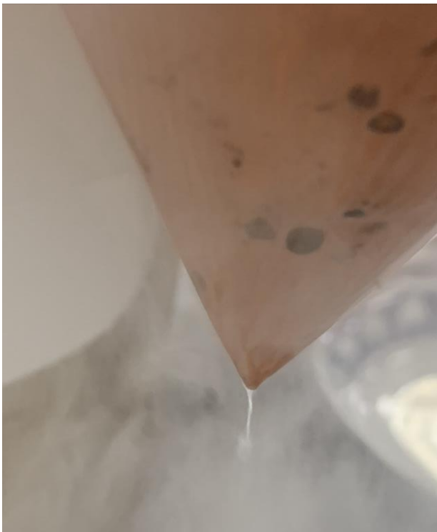
図 2. 空気中の酸素などが凝縮し、円錐容器の先端から滴り落ちる様子。
