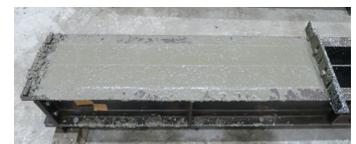
写真-4 コンクリート打設後
