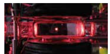
超高真空ガラスセル中で磁気光学トラップされている冷却Li原子気体 Magneto-optical trapping of cold Li atoms in an ultra-high vacuum glass-cell
