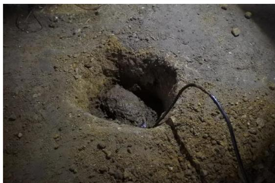
Fig. 3-43 水ポテンシャルセンサー設置状況
