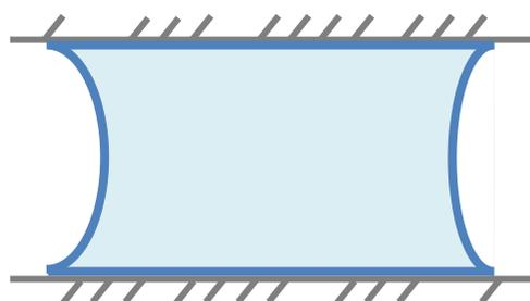
Fig. 2-7 毛管水（毛細管凝縮水）のモデル図
