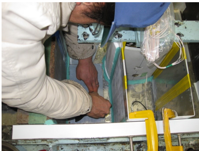
写真-4.11 テフロンシートおよび紙粘土取り付け状況
