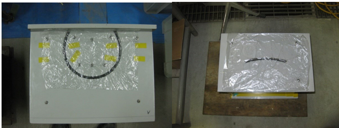
写真-4.2 使用した型枠（左：覆工，右：インバート）
