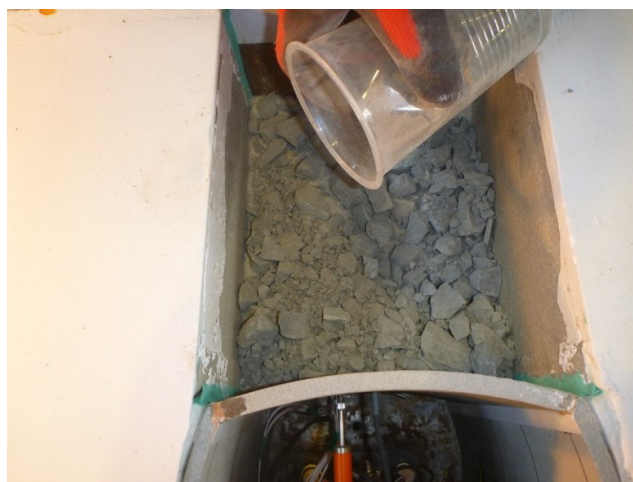
写真-4.14 泥岩敷きつめの状況
