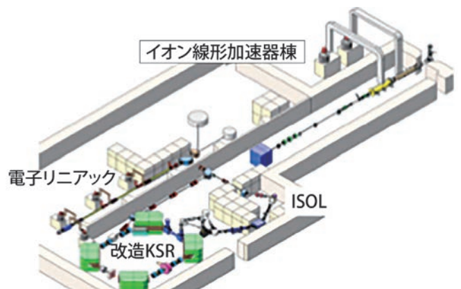
改造後の加速器施設
