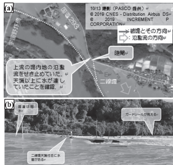
図 6 久慈川・二線堤の決壊状況
