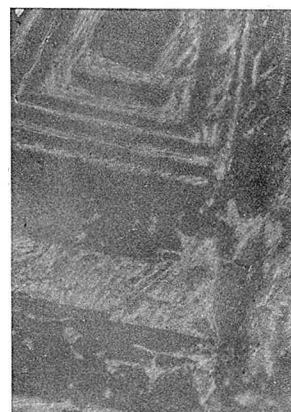
Fig. 4. Regulus m. 70% Te ; m. warmer verd. HNO 3 geätzt. 168 fache Vergr.
