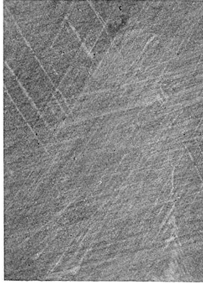
Fig. 1. Regulus m. 61.4% Te ; m. warmer verd. HNO 3 geätzt. 168 fache Vergr.
