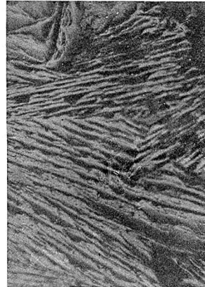
Fig. 2. Regulus m. 30% Te ; m. warmer verd. HNO 3 geätzt. 168 fache Vergr.
