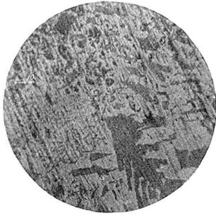
Fig. 1. Regulus mit 20% Pb; mit  $\text{HNO}_3$
