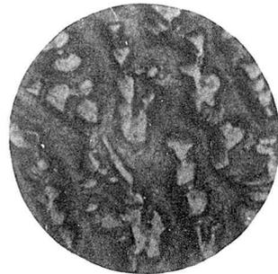
Fig. 4. Regulus mit 90% Pb; mit  $\text{HNO}_3$
