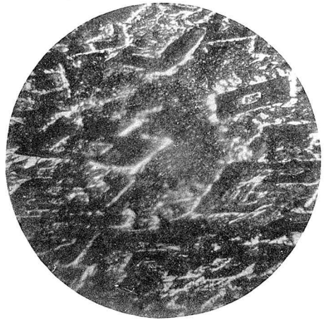
Fig. 6. Regulus mit 47.5% Se; geätzt mit konz. \text{HNO}_3 : \text{Tl}_2\text{Se}_3 + \text{Eutektikum} . 250 f. Vergr.
