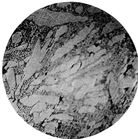
Fig. 4. Regulus mit 25% Se; geätzt mit konz. HNO_3 ; TlSe + Eutektikum. 250 f. Vergr.
