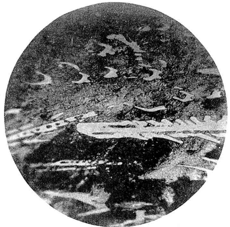
Fig. 9. Eutektikumschicht beim Regulus mit 90% Se; geätzt mit konz. \text{HNO}_3 . 250 f. Vergr.
