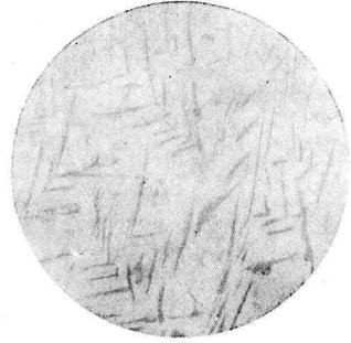
Regulus m. 42.5% Se; geätzt m. verd.  $\text{HNO}_3$
