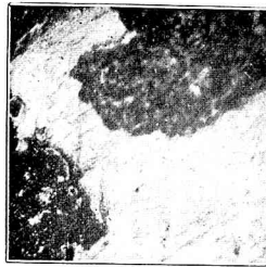
Regulus von 99% Se : \text{Se} + \text{Al}_3\text{Se}_4 . 250 f. Vergr.
