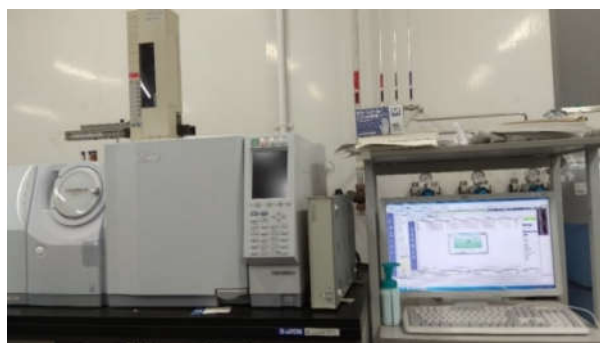
Fig. 3.2 Analysis using GC-MS QP2010 SE
