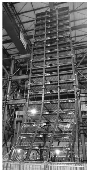
図 1.2 最終崩壊形
