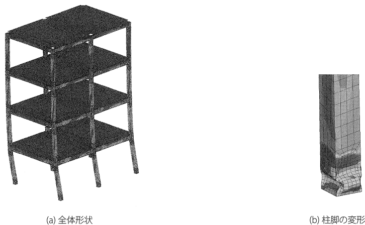
図8 地震外力を受ける4層鋼構造骨組の変形状態と応力分布
