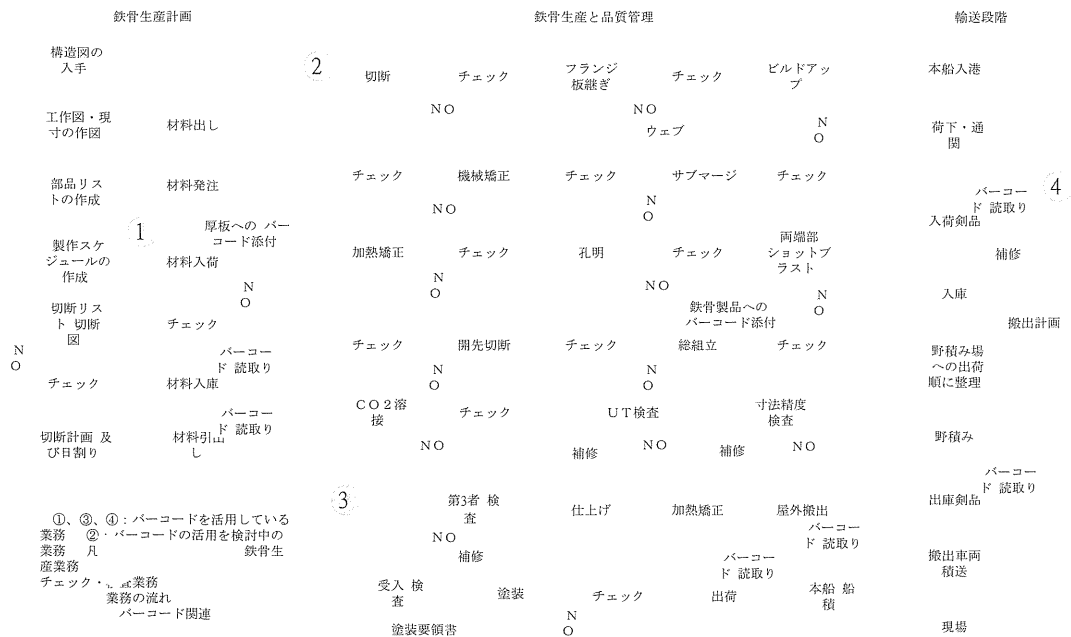
図 2 鉄骨生産プロセス：大梁（出典：M 社の資料に基づいて金貞坤作成）
