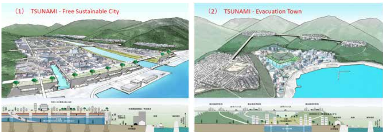
図3 人工地盤・中高層建築物による復興(出展:第2回東日本大震災復興構想会議河田委員資料)
