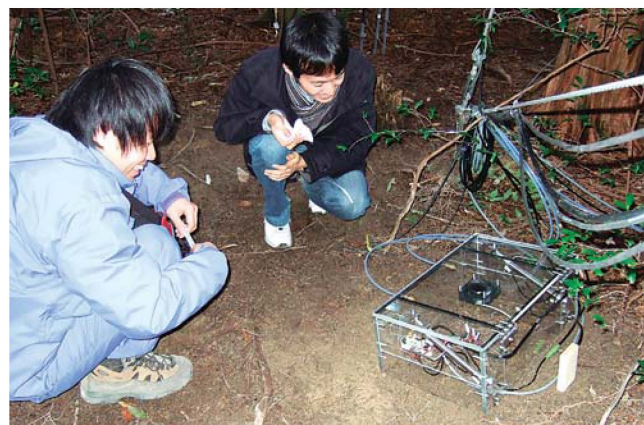
土壌と大気間のガス交換フラックスを測定する自動開閉チャンバーの設置作業。
