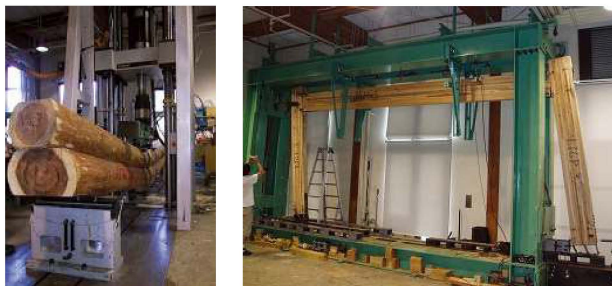
図 7 実大耐力実験装置(左:1000kN サーボアクチュエーター、:右 300kN 反力フレーム)
