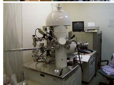
図 8 新規木質系複合材料の開発実験(上)、X線光電子分析装置(ESCA)
