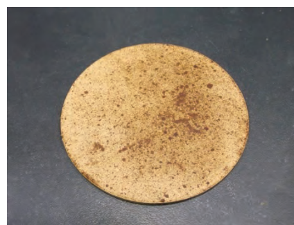
図1：スクロース・リン酸二水素ナトリウム接着木質成形体
