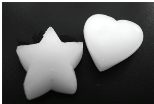
図5. 35wt%NaOH水溶液(50°C)で作製した \beta -キチンナノファイバー由来のハイドロゲル
