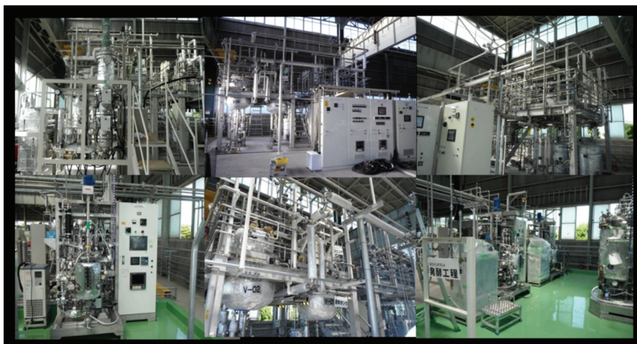
図2 NEDOプロジェクトで開発したバイオエタノールベンチプラント 左上写真が開発したマイクロ波照射装置。H25年度からバイオマスからの 化学品生産などバイオリファイナリー研究全般に活用している。
