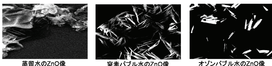
図 4 : 無機化学合成に微細気泡を利用した際の結晶化の違い
