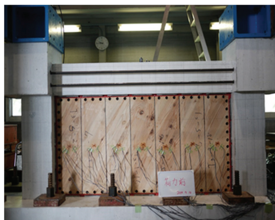
図2：鉄筋コンクリート造と CLT の構造実験
