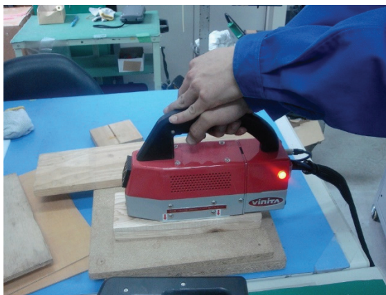
図 4：試作した木材害虫駆除用高周波照射装置による処理(写真提供・飯田高雄氏)
