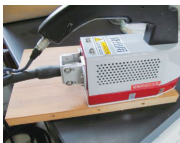
図3-1：高周波発振装置を用いた殺虫処理
