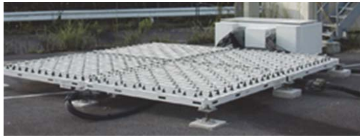
図2-8：下部対流圏レーダーのアンテナ
