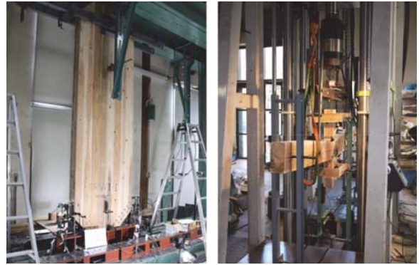
CLT を用いた耐力壁の開発や伝統建築の仕口の力学挙動解明の実験
