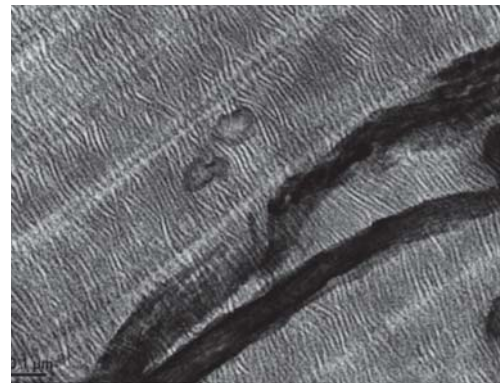
図 4-23：射出成形後に観察されるシシケバブ構造 (CNF 強化 HDPE)
