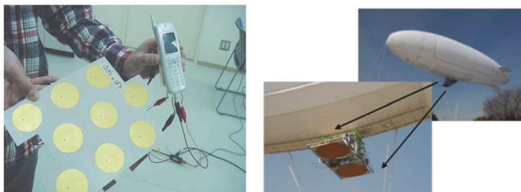
図3-6：京都大学による携帯電話のマイクロ波無線充電実験 (a) 室内ユビキタス電源（2004）、(b) 屋外緊急時電源（飛行船からのマイクロ波送電）（2009）
