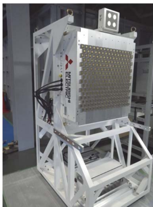
高度マイクロ波無線電力伝送用フェーズド アレイシステム
