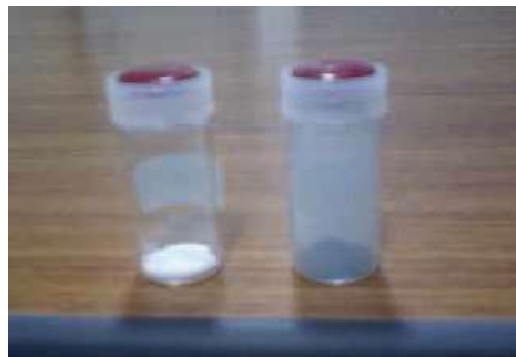
TiO 2 のマイクロ波還元(左：照射前、右：照射後)
