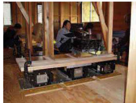
写真8 小型起震機によるエコ住宅の振動性能実験
