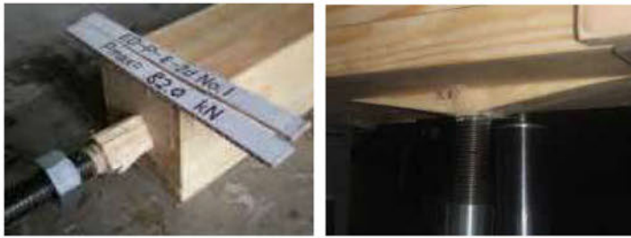
(左) 繊維平行方向 (右) 繊維直交方向 写真 10 GIR 接合の破壊形態
