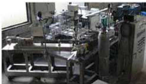
バイオマス変換用連続式マイクロ波照射装置 Continuous microwave irradiator for biomass conversion
