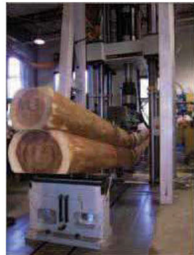
写真4 1,000 kN 縦型サーボアクチュエーター試験機を用いた京都府木橋用スギ丸太2層接着重ね梁の曲げ破壊実験の様子
