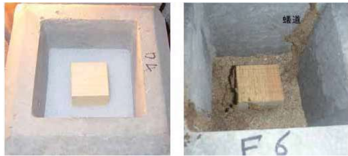
写真7 エコ住宅床下での粒子材料貫通試験状況。左：シリカゲルビーズ層（貫通無し）右：コントロール（貫通有り）
