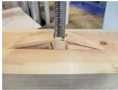
図 10 接着界面でのせん断破壊による接合具の引き抜け状況。
