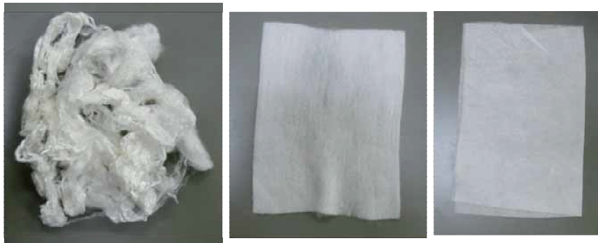
図1. マリンナノファイバーを配合天然繊維. (左) ワタ、(中) 不織布（ニードルパンチ）、(右) 不織布（スパンレース）.
