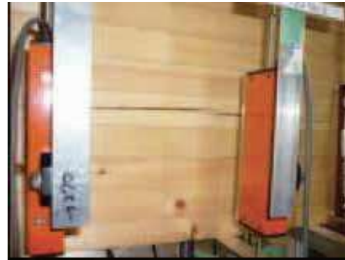
写真7 割裂破壊の様子
