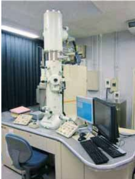
無機用電界放出形電子顕微鏡
