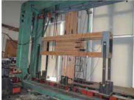
写真5 鋼製反力フレーム
