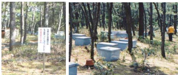
生活・森林圏シミュレーションフィールド（LSF） 左より時計回りに、LSF 入口、木材・木質材料の防蟻野外試験
