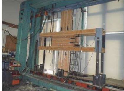
写真5 鋼製反力フレーム
