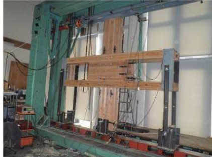
写真5 鋼製反力フレーム
