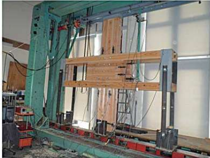
写真5 鋼製反力フレーム
