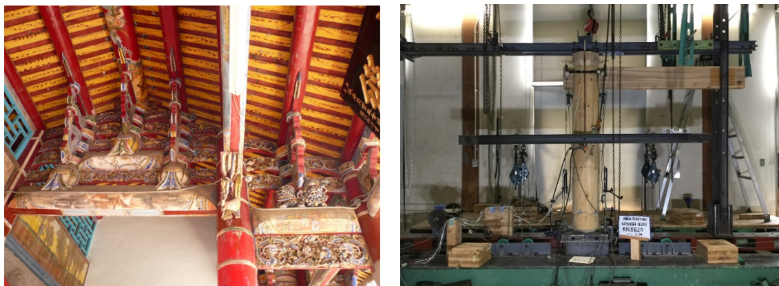
図5：(左)台湾の伝統木造架構の例、(右)組み物を有する柱梁架構の水平加力試験体
