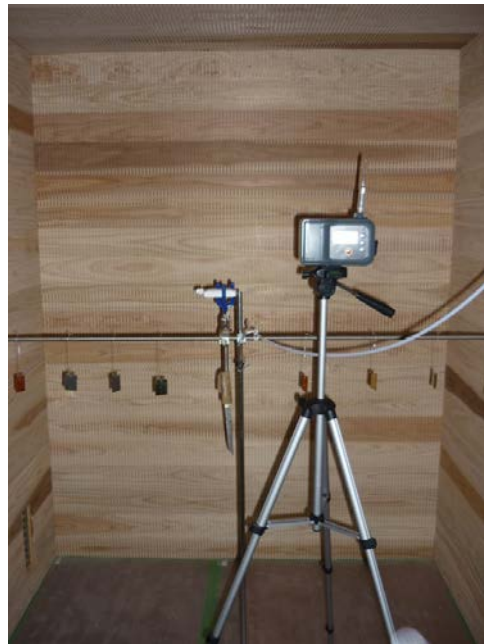
図B 保管庫内に捕集管設置
