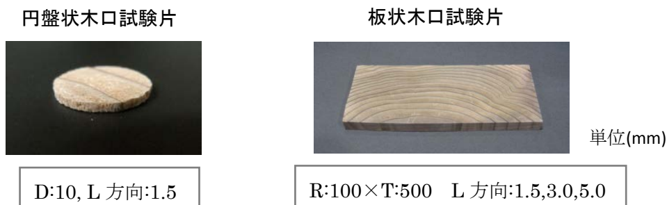
図 1 通気実験に用いた木口試料の形状
