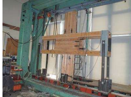
写真5 鋼製反力フレーム
