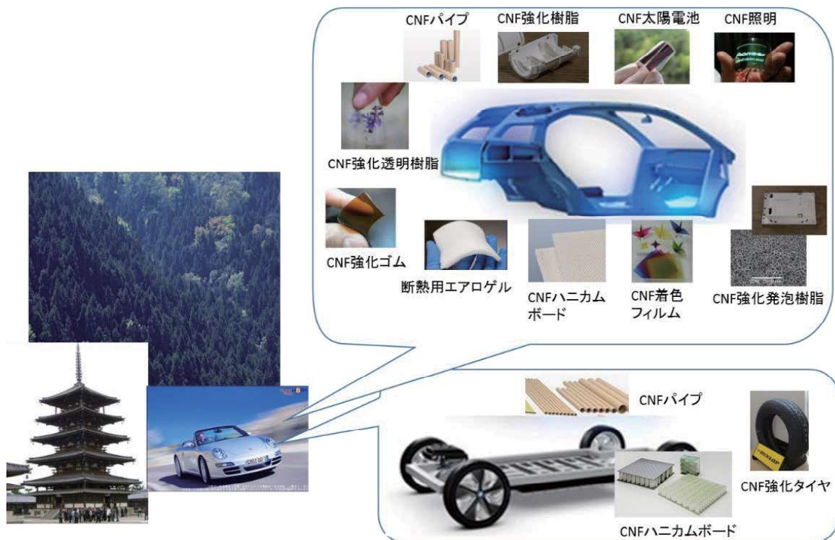
図5 様々なセルロースナノファイバー材料を活用したNCV
