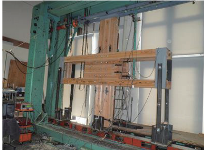
写真5 鋼製反力フレーム
