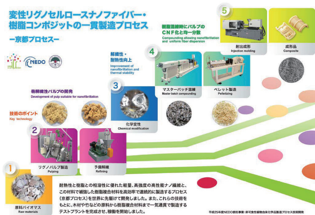
図4 パルプ直接混練法”京都プロセス“の概略
