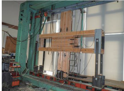
写真5 鋼製反力フレーム
