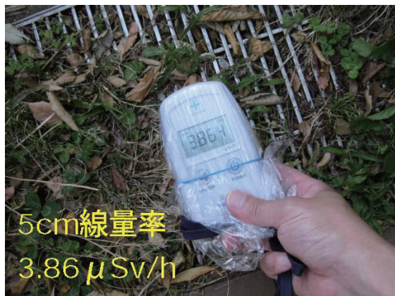
図1 典型的なミニホットスポット。我々の生活圏に無数のミニホットスポットが形成され、高濃度の放射性物質がむき出しになっている。
