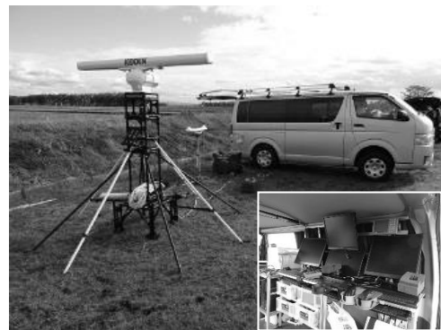
写真 1 FRS の可搬型船舶レーダとデータ収録 PC
