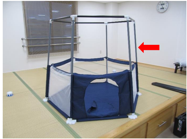
写真 3 : 鉛直方向のパイプを入れ替え
